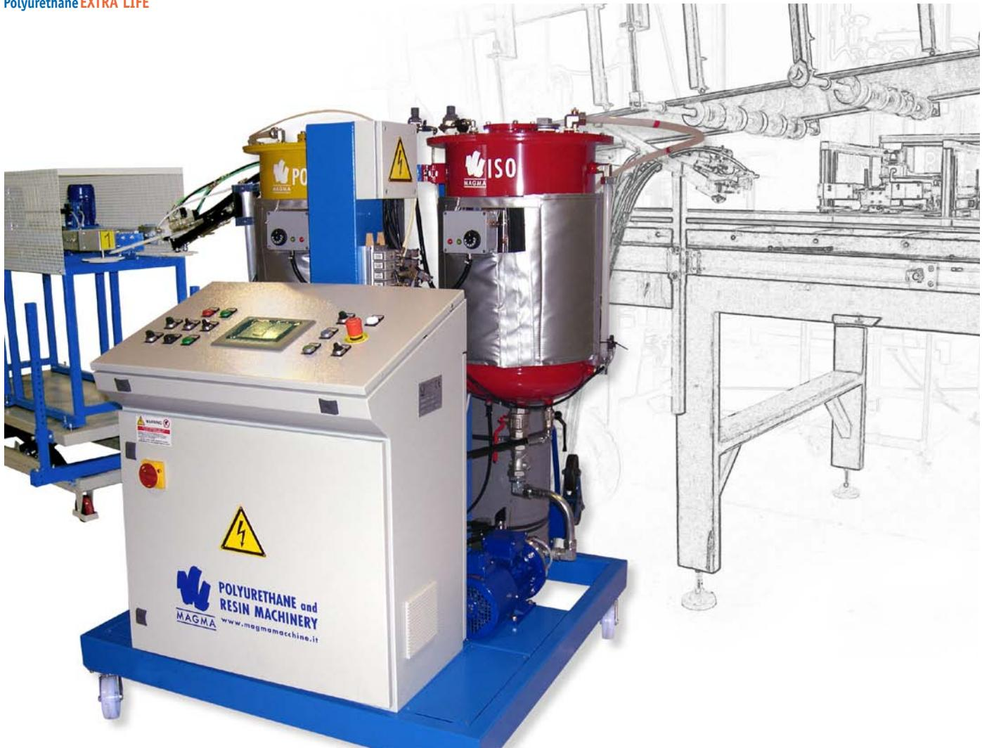
La Stazione Primer DPR è utilizzata per miscelare un poliuretanico distribuito sulla lamiera inferiore di un pannello sandwich come uno strato sottile (film). Viene così ottimizzata l'adesione tra la lamiera inferiore del pannello e la schiuma PIR applicata successivamente. La stazione, di norma, viene posizionata tra il forno di pre-riscaldo e la traversa di schiumatura.
